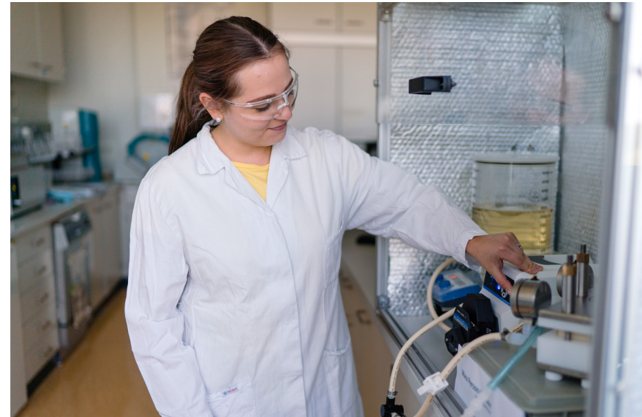
Reinigung der Produkte über Querstromfiltration
