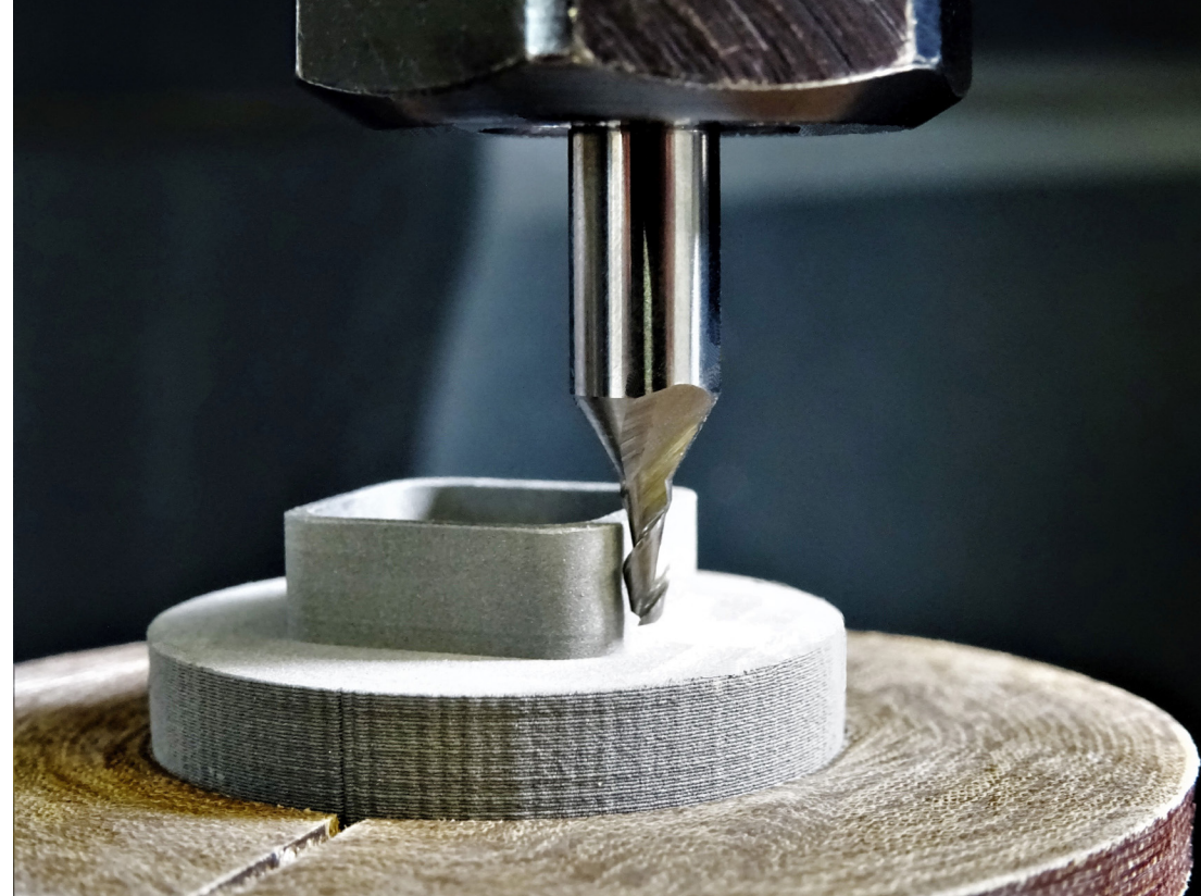
Grünbearbeitung eines kompakten NiTi Teils gefertigt über Fused Filament Fabrication (FFF)
