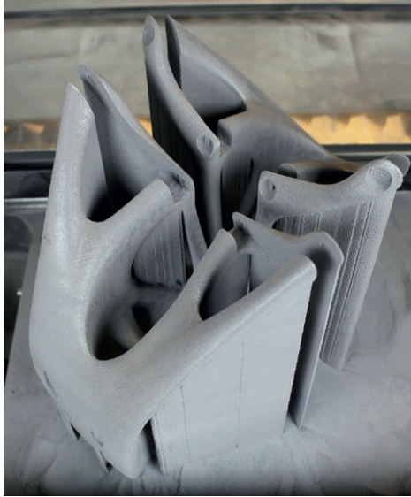
Longboard-Träger im Pulverbett der Laserstrahlschmelzanlage
