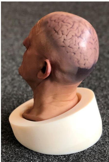
Transluszentes Kopfmodell: Multimaterial-3D-Druck mit dem universellen 3D-Druckertreiber Cuttlefish. | © Fraunhofer |
