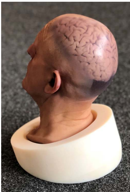
Transluzentes Kopfmodell: Multimaterial-3D-Druck mit dem universellen 3D-Druckertreiber Cuttlefish. | © Fraunhofer |
