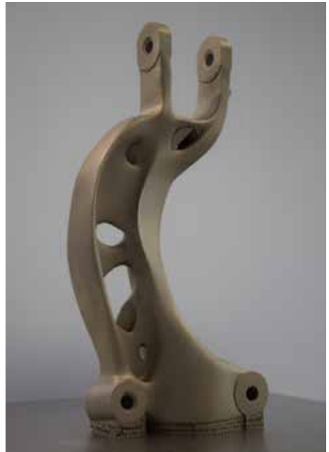
Ressourcenoptimiertes Design einer KFZ-Dämpfergabel
