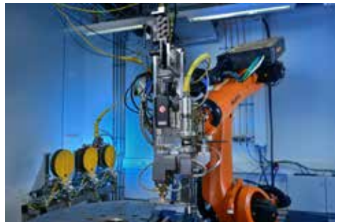
Die im Projekt ProLMD (BMBF-Fördermaßnahme ProMat3D) entwickelte Anlagentechnik für Draht-LMD ermöglicht Aufbau und Bearbeitung von Großbauteilen in hoher Qualität bei optimaler Materialausnutzung und senkt so die Prozesskosten.
