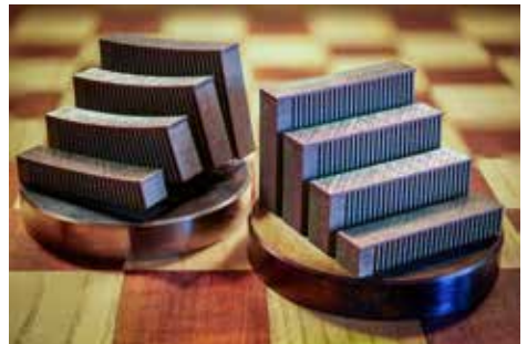
Mit einem NIR-Strahler an der Beschichtereinheit lässt sich der Verzug im Bauteil signifikant reduzieren.
