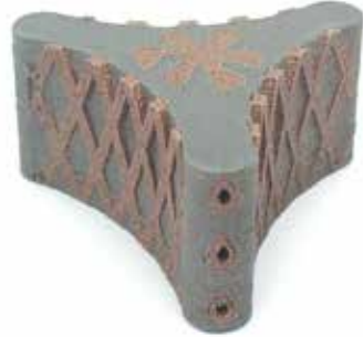
Multimaterialbauteil aus dem Laserstrahlschmelzprozess aus Werkzeugstahl und Kupfer-Chrom-Zirkonium
