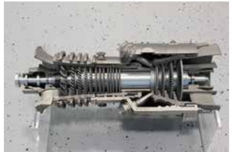
Skaliertes Modell einer Gasturbine zur Stromerzeugung; komplett mit additiven Verfahren hergestellt.
