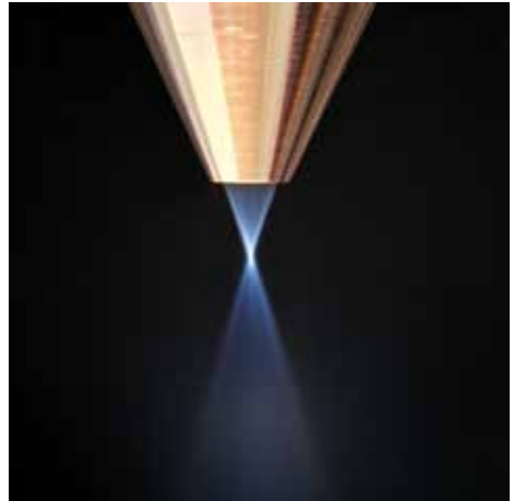
Werkzeug »Pulvergasstrahl«: Mit dem Powder Jet Monitor kann erstmals dokumentiert werden, wie Düsen den Pulvergasstrom, die Verteilung der Partikeldichte und andere Parameter beeinflussen.
