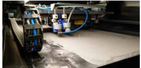
Kinematik zur Integration von Komponenten in Bauteile während des Laserstrahlschmelzprozesses, eingebaut in eine Laserstrahlschmelzanlage
