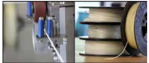
Aus entwickelten Werkstoffen werden Filamente für den 3D-Druck.
