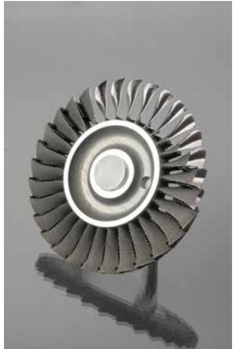
Additiv hergestellte und anschließend spanend bearbeitete BLISK
