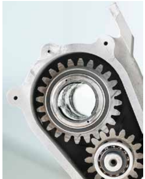
Multimaterial-Getriebe; Einzelteile hergestellt mittels Additiver Fertigung
